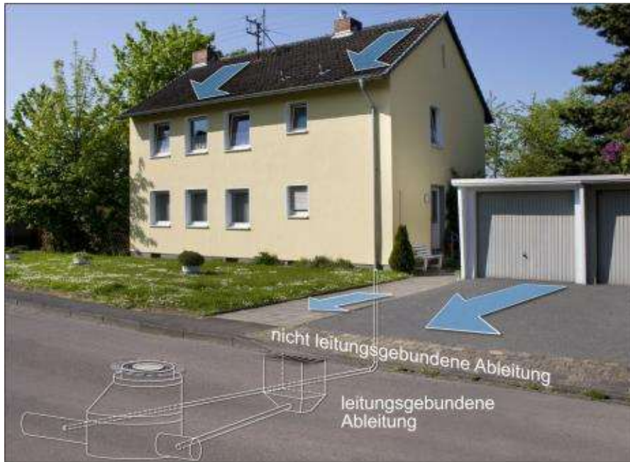
Beispiel für direkten und indirekten Anschluss an die öffentlichen Entwässerungsanlagen
