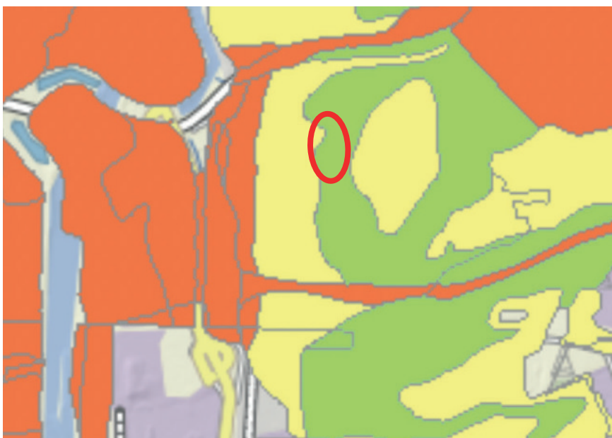
Versickerungsfähigkeit des Bodens (grün = geeignet, gelb = bedingt geeignet, rot = ungeeignet); Quelle: LVGL, GeoPortal Saarland, Stand der Abfrage: 27.04.2022)
